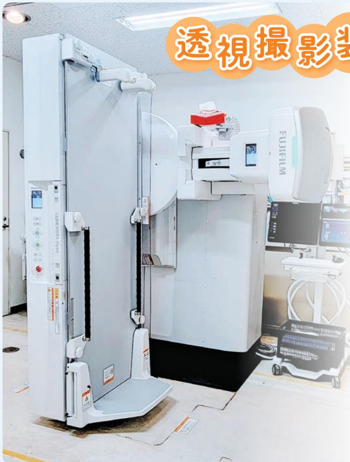
1月11日より新しい透視撮影装置が導入されました。透視撮影装置は主に、健診における胃のバリウム検査、医師がリアルタイムに透視画像を見ながら行う骨折・脱臼の整復や造影剤を注入しながらの透視観察・撮影、内視鏡装置を併用しながら行う胆石の除去などの処置・治療など、多目的に使われる装置です。従来の装置はX線を検出して発生する光をCCDカメラで画像化していましたが、新しい装置は発生した光を電気信号に変換して画像化します。そのため従来よりも広視野で高画質な画像を、低被ばくで得ることができるようになりました。また最新の画像処理技術により、高精細で低ノイズな画像が得られます。他にも、寝台の広い範囲が撮影可能エリアとなっているため寝台の左右移動が無く、乗り降り用に寝台自体をかなり低くできるので患者様の移動や検査中の安全に配慮された装置となっています。
